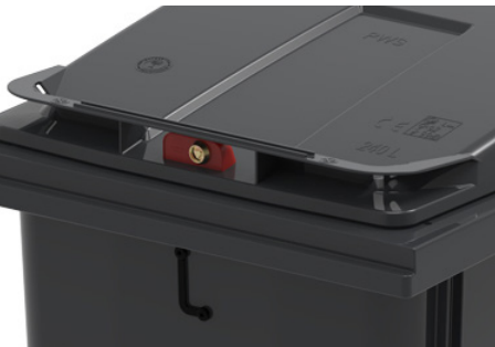
GRAVITATIONSLSÅS Gravitationslåset låser upp sig automatiskt vid en viss vinkel när kärlet töms och låser sig igen när det ställs tillbaka. Endast kunden behöver nyckel, inte renhållarna. Art.nr 844 140
